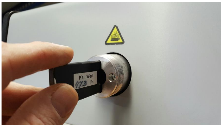
Figur 16. Indsæt det optiske filter i røgkammeret.
