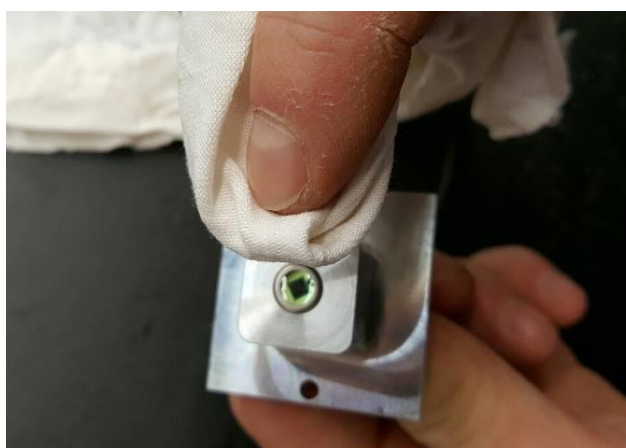
Figur 17. Rengøring af modtageren af røgmåleren.
